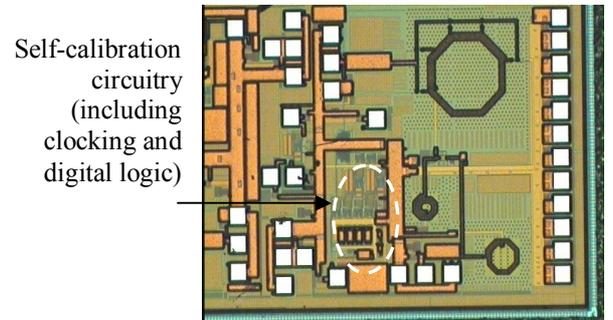
Fig. 5 Chip micrograph of a 1.9 GHz LNA
